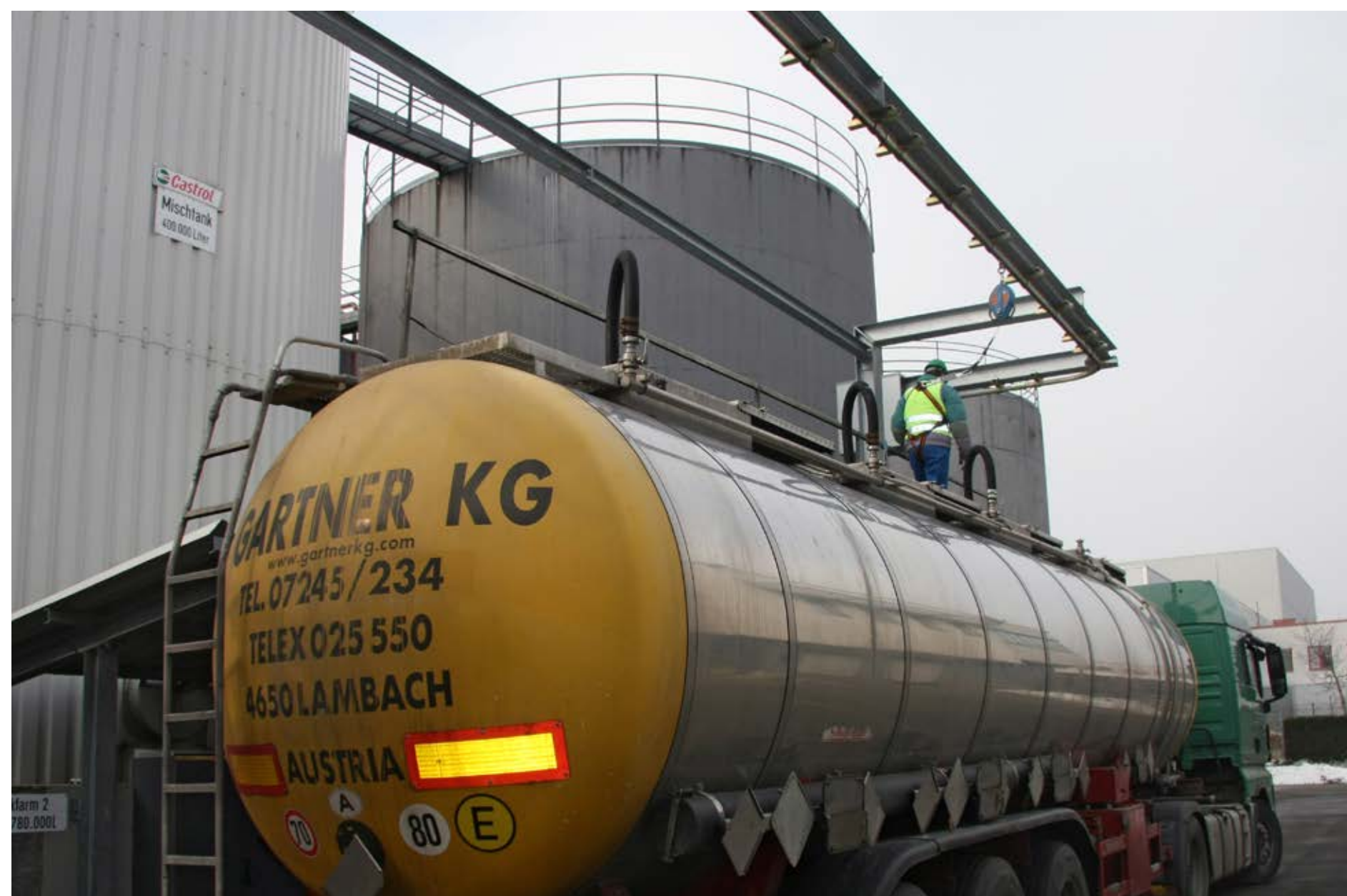
Freistehendes Personensicherungssystem mit Bogen für Servicearbeiten im Freien an Lastkraftwägen.
