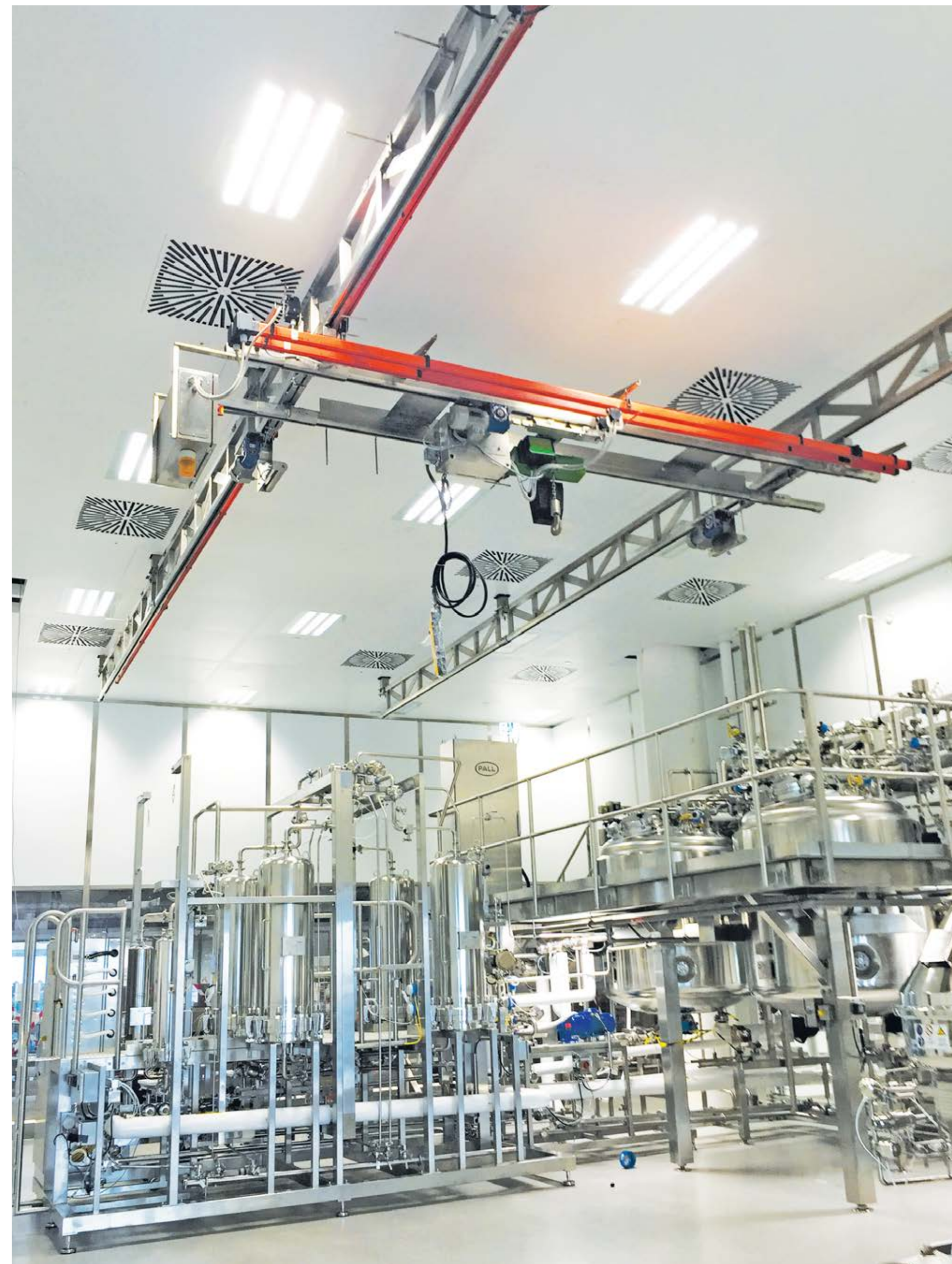
Vollständig motorisierte Brückenkrane aus rostfreiem Stahl mit hochgezogenen Doppelträgern und Abstützung für Stromschienen in der pharmazeutischen Industrie.
