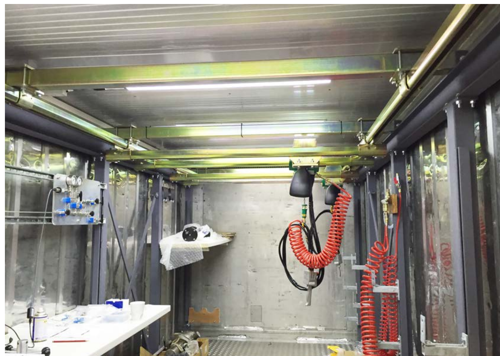
Leichtkran mit geringer Bauhöhe bei beengten Platzverhältnissen.
