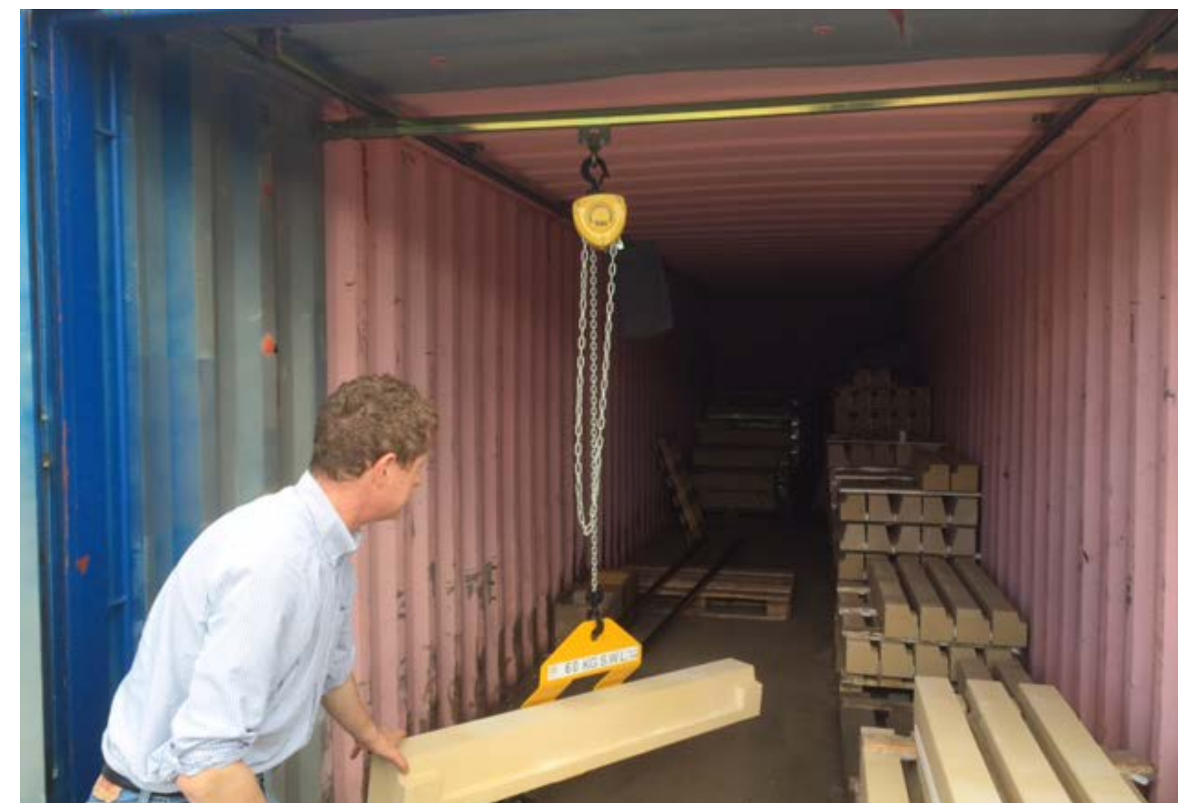
Kran zum Beladen und Positionieren von Gütern auf Paletten im Container.
